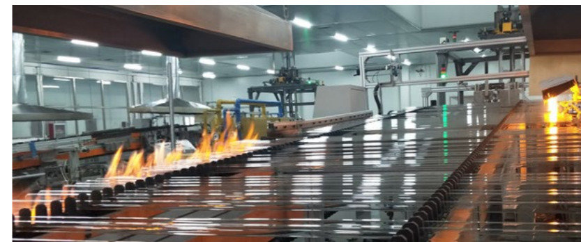
凯盛科技中性硼硅药用玻璃管生产线
