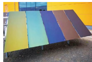
凯盛科技生产的 30x30 厘米铜铟镓硒 (CIGS) 太阳能电池组件的光电转换效率达到 19.8%，再次打破世界纪录
