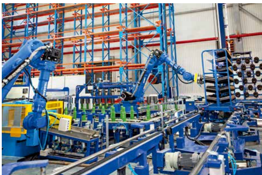
碳纤维智能包装线，实现碳纤维产品包装全流程自动化
