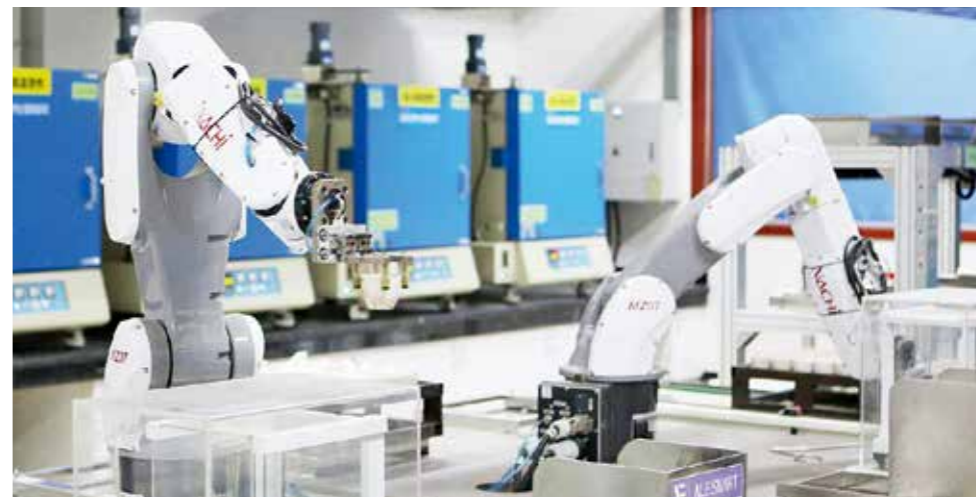
泰山玻璃纤维股份有限公司自动化原丝质检
