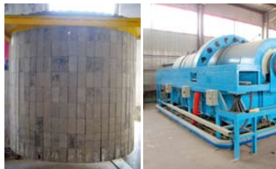
正在研制的陶瓷预热器内筒
